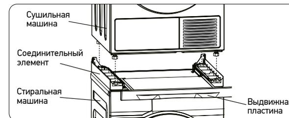
7. Возьмите два винта, которые были сняты до этого, вставьте их в отверстия, соединяющие элемент и нижнюю часть задней стенки сушильной машины, и затяните.
