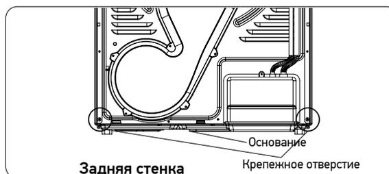
4. Отрегулируйте высоту четырех ножек сушильной машины таким образом, чтобы можно было вставить ограничитель высоты ножек, и высота составляла около 11.5 мм.
