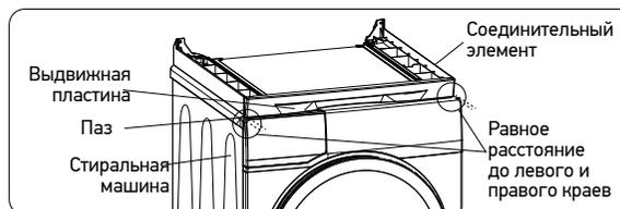
2. Прикрепите соединительный элемент к верхней поверхности стиральной машины четырьмя самонарезающими винтами.
