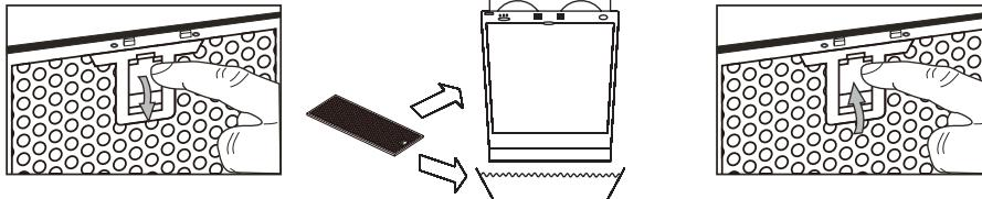
Рекомендуется производить очистку металлического жирового фильтра не реже 1 раза в 3 месяца, следуя следующим указаниям:
