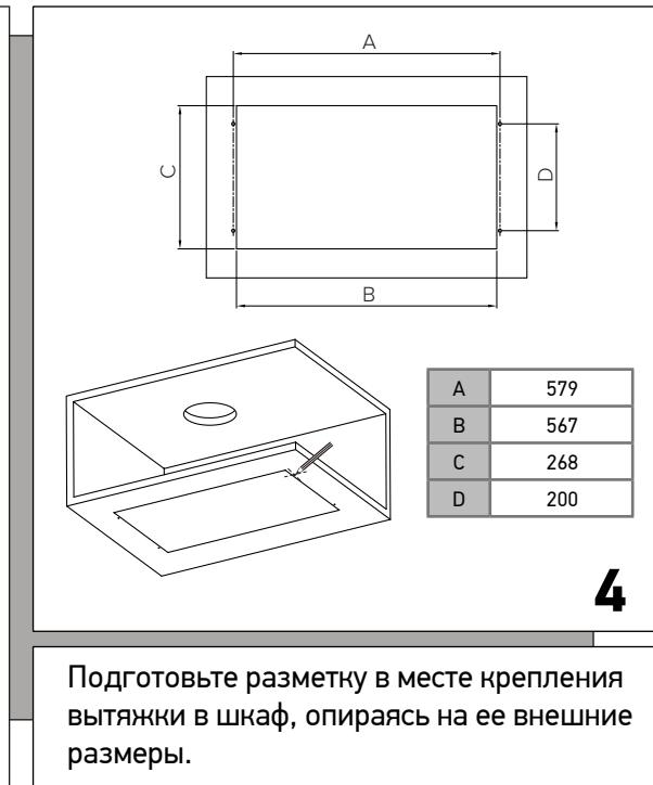
Подготовьте разметку в месте крепления вытяжки в шкаф, опираясь на ее внешние размеры.
