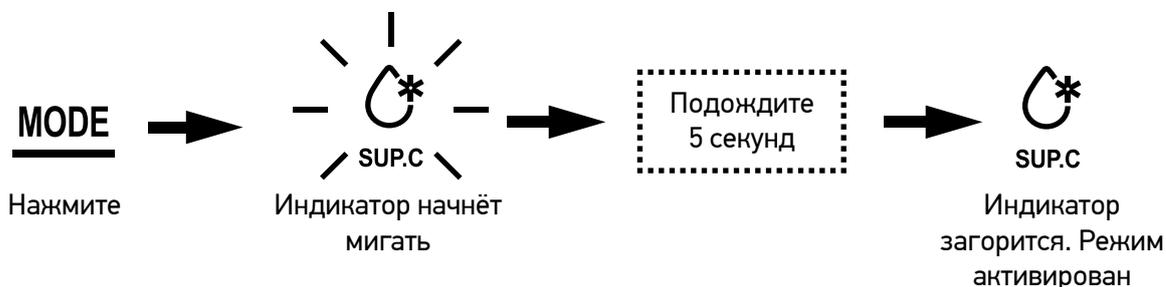
Для выхода из режима быстрого охлаждения нажмите кнопку «MODE», индикатор быстрого охлаждения начнёт моргать. Через 5 секунд индикация быстрого охлаждения погаснет и режим будет выключен.
