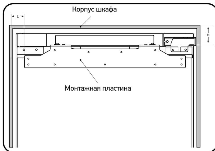
6. Ослабьте колпачковые винты крышки, затем снимите монтажную пластину.
