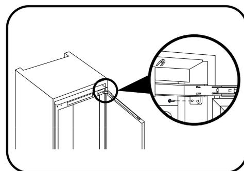
4. Поверните регулировочные ножки, чтобы привести холодильник и шкаф в требуемое положение. Закрепите регулировочные ножки с помощью винтов. Затем прикрутите верхнюю часть холодильника. Панель крепится к верхней части шкафа, а винты закрываются накладками.
