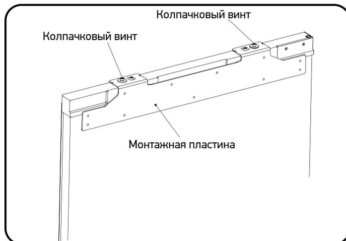
7. Закрепите монтажную пластину на дверце шкафа с помощью винтов.
