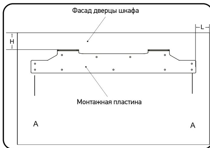
8. Закрепите фасад дверцы шкафа на дверце холодильника с помощью монтажной пластины с помощью винтов. Не затягивайте винты слишком сильно, позже их нужно будет ослабить.
