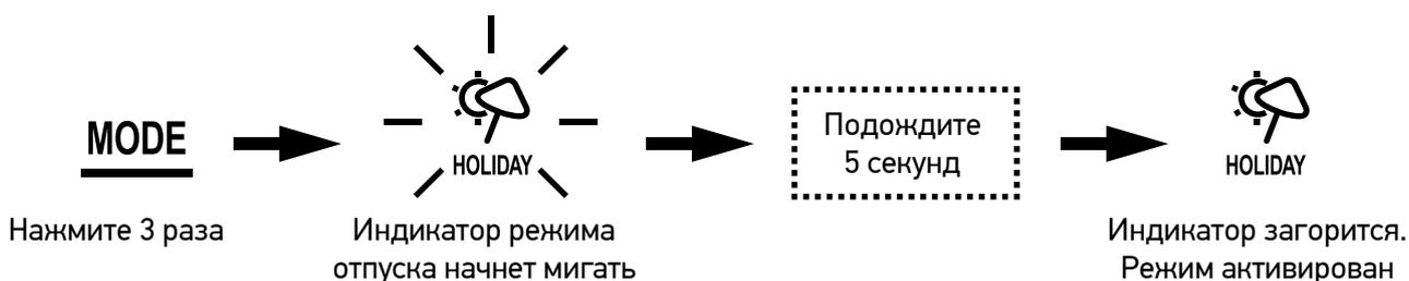
Для выхода из режима отпуска нажмите кнопку «MODE» 3 раза, индикатор режима отпуска начнёт моргать. Через 5 секунд индикация режима отпуска погаснет и режим будет выключен.
