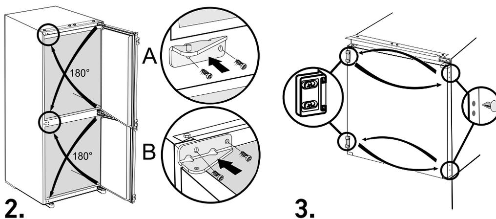
По умолчанию двери холодильника открываются с левой стороны. Чтобы изменить направление открывания дверей, поменяйте верхнюю и нижнюю дверные петли местами и установите их на левой стороне корпуса холодильника. После этого установите переднюю верхнюю пластину в верхней части холодильника и закрепите с помощью винтов.
