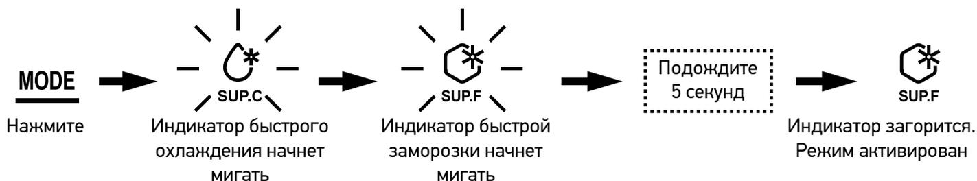
Для выхода из режима быстрой заморозки нажмите кнопку «MODE», индикатор быстрой заморозки начнёт моргать. Через 5 секунд индикация быстрой заморозки погаснет и режим будет выключен.
