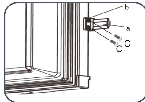
10. Предварительно закрепите винтом неподвижную балку на холодильнике, отрегулируйте положение справа и слева, чтобы его боковая сторона прижалась к боковой стенке шкафа, а затем закрепите их с помощью винтов, после чего окончательно закрепите холодильник с неподвижными балками и закройте крышку.
