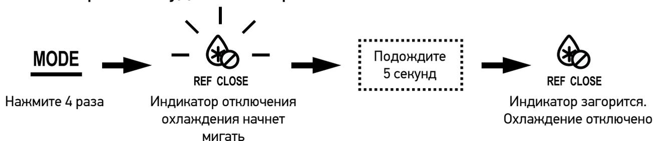
Для включения охлаждения нажмите кнопку «MODE» четыре раза, индикатор отключения охлаждения начнёт моргать. Через 5 секунд индикация «REF CLOSE» погаснет и режим будет выключен.
