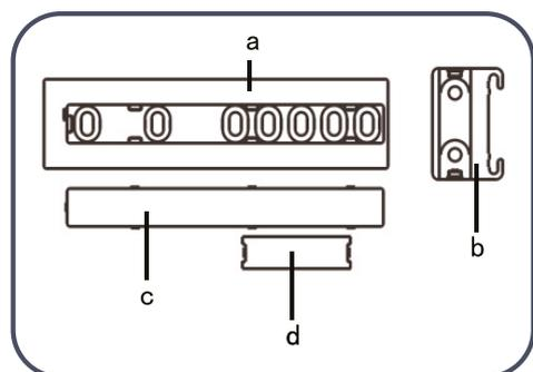
6. Согласно положению рельсов на рисунке, приложите рельс (a) к внутренней стенке двери шкафа и закрепите их винтами.
