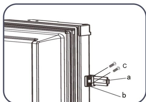
9. Закрепите крышку рельса (с) в направляющие (b). Согласно вышеизложенному методу закрепите дверцу холодильника на дверце шкафа оставшимися тремя компонентами рельса.
