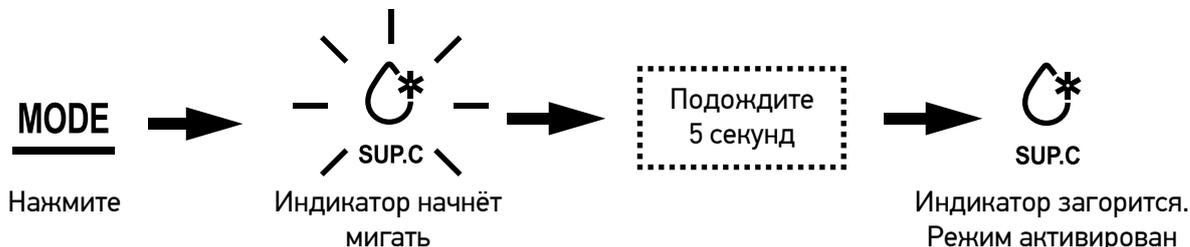
Для выхода из режима быстрого охлаждения нажмите кнопку «MODE», индикатор быстрого охлаждения начнёт моргать. Через 5 секунд индикация быстрого охлаждения погаснет и режим будет выключен.
