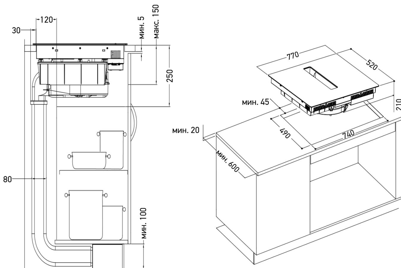
Для правильной и безопасной эксплуатации варочной панели при установке необходимо обеспечить вентиляционные зазоры. Следуйте приведенным ниже рекомендациям.
