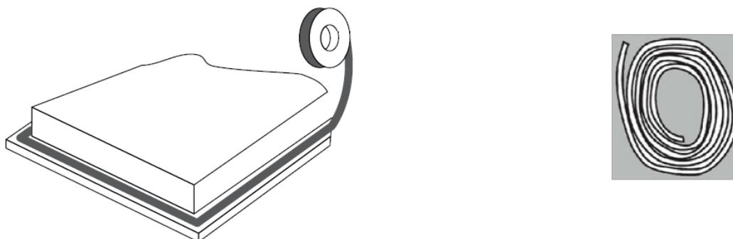
Уплотнитель идет в комплекте с варочной панелью. Уложите уплотнитель по всему периметру отверстия для монтажа.
