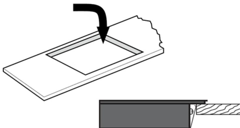
При установке варочной панели не используйте клей. После укладывания уплотнителя, поместите варочную панель в монтажное отверстие. Легко надавите. Убедитесь, что варочная панель установлена ровно и ее выступающие края плотно прилегают к поверхности столешницы.
