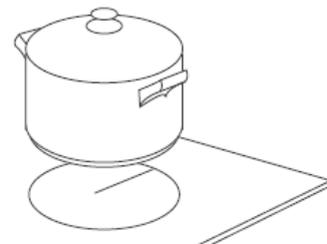
3. С помощью соответствующей кнопки выберете зону нагрева, на которой размещена посуда. Индикатор мощности выбранной конфорки будет мигать. Если вы не выберете зону нагрева в течение 1 минуты, варочная панель автоматически отключится. Включите её повторно долгим нажатием на кнопку включения «**I**».
