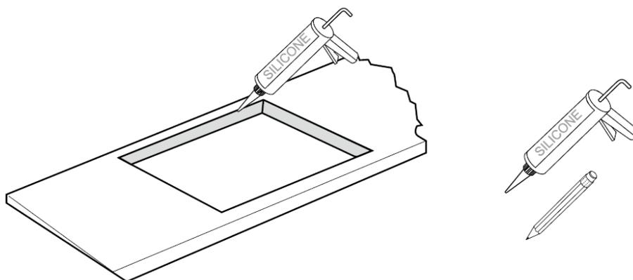
Сделайте выпил в столешнице, используя подходящее оборудование. Обработайте края выпила специальным силикатным герметиком. Дождитесь его высыхания.
