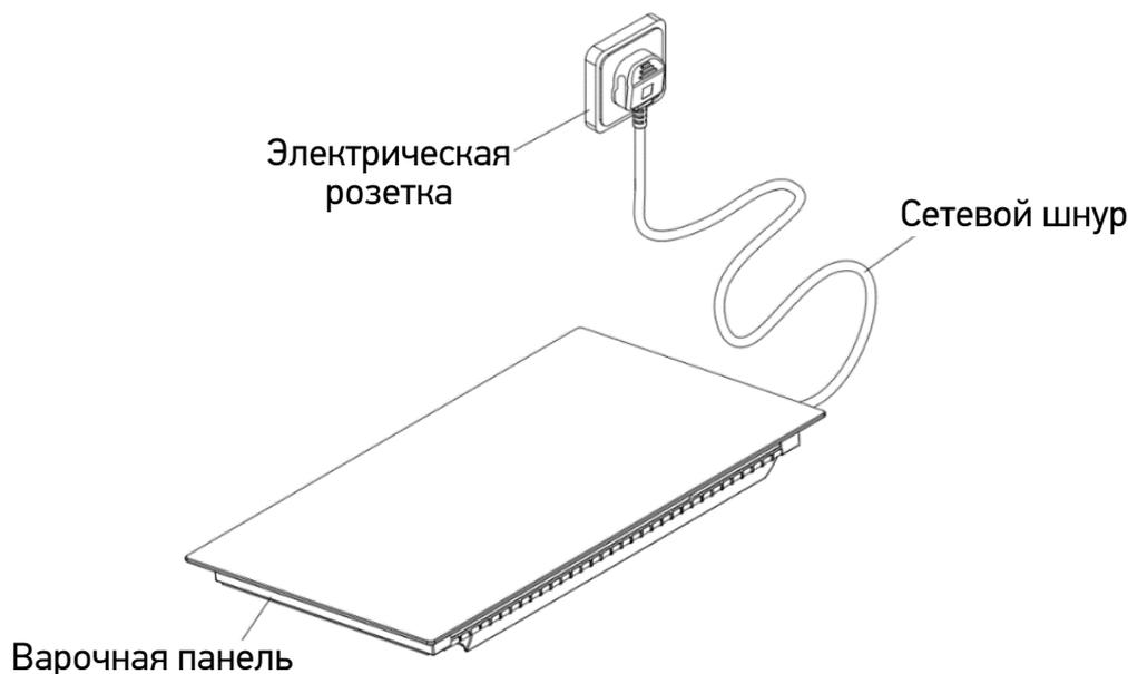
Во избежание несчастного случая, замену поврежденного шнура питания может производить только сотрудник сервисного центра с использованием специальных инструментов.
