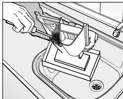
1. Выньте отсек, вытягивая его по направлению к себе и нажав на область, указанную на рисунке.
