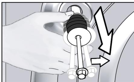
2. Осторожно выкрутите и выньте предохранительные транспортировочные болты.
