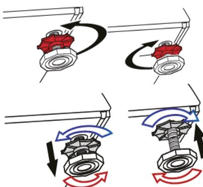
1. Ослабьте стопорные гайки на ножках вручную.
