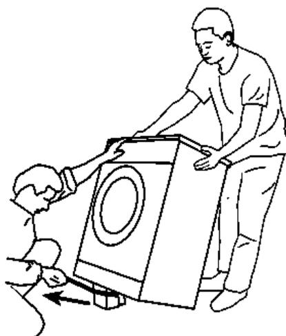
Чтобы удалить элементы жесткости, наклоните машину назад и потяните за ленту.
