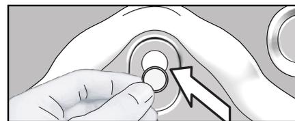
3. Закройте отверстия на задней стенке пластиковыми заглушками, которые находятся в пакете с инструкцией по эксплуатации.
