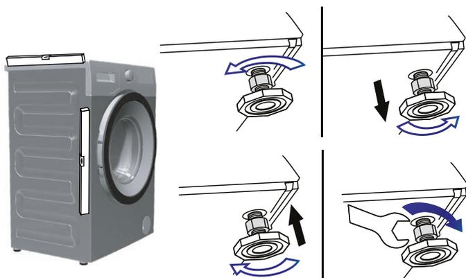
1. Ослабьте контргайки на ножках с помощью гаечного ключа.
