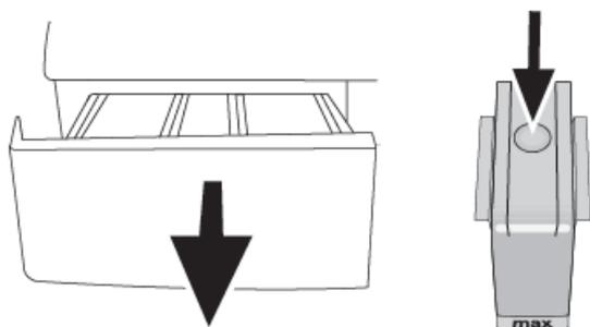
1. Чтобы вынуть из машины распределитель моющих средств, нажмите на сифоне в отделении для кондиционера на точку, указанную пунктиром, и потяните распределитель на себя.
