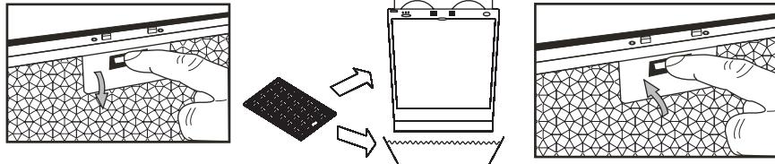
Рекомендуется производить очистку металлического жирового фильтра не реже 1 раза в 3 месяца, следуя следующим указаниям:
