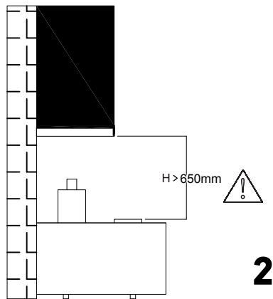
Минимальное расстояние от нижней точки вытяжки до варочной панели - 650мм; максимальное - 750 мм.
